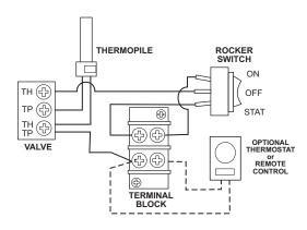
Figure 16. GI425 Valve Wiring Diagram
